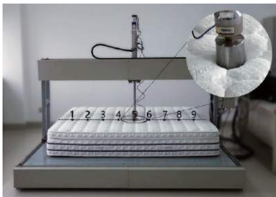
图 7 床垫纵向各层硬度测试的方法
